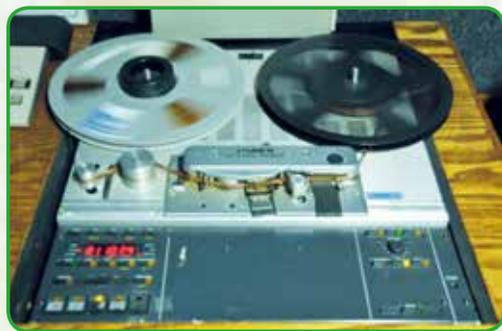
時的磁帶就經過錄音機的磁頭錄制或播放節目。磁帶是透過磁粉轉化成聲音。磁帶是可以剪輯和接駁，透過消磁頭或消磁機更可以重新使用那卷磁帶；磁帶需要很大的儲存空間，運送非常不便；而且磁帶帶有微弱雜聲，都是它的限制。短波受環境影響令收聽效果欠理想；因此制作團隊會認真做好節目每一部分：包括錄音的音量要清晰、盡量清除錄音時的雜音，用最好的效果讓收音機旁的朋友聽到最好的信息。
